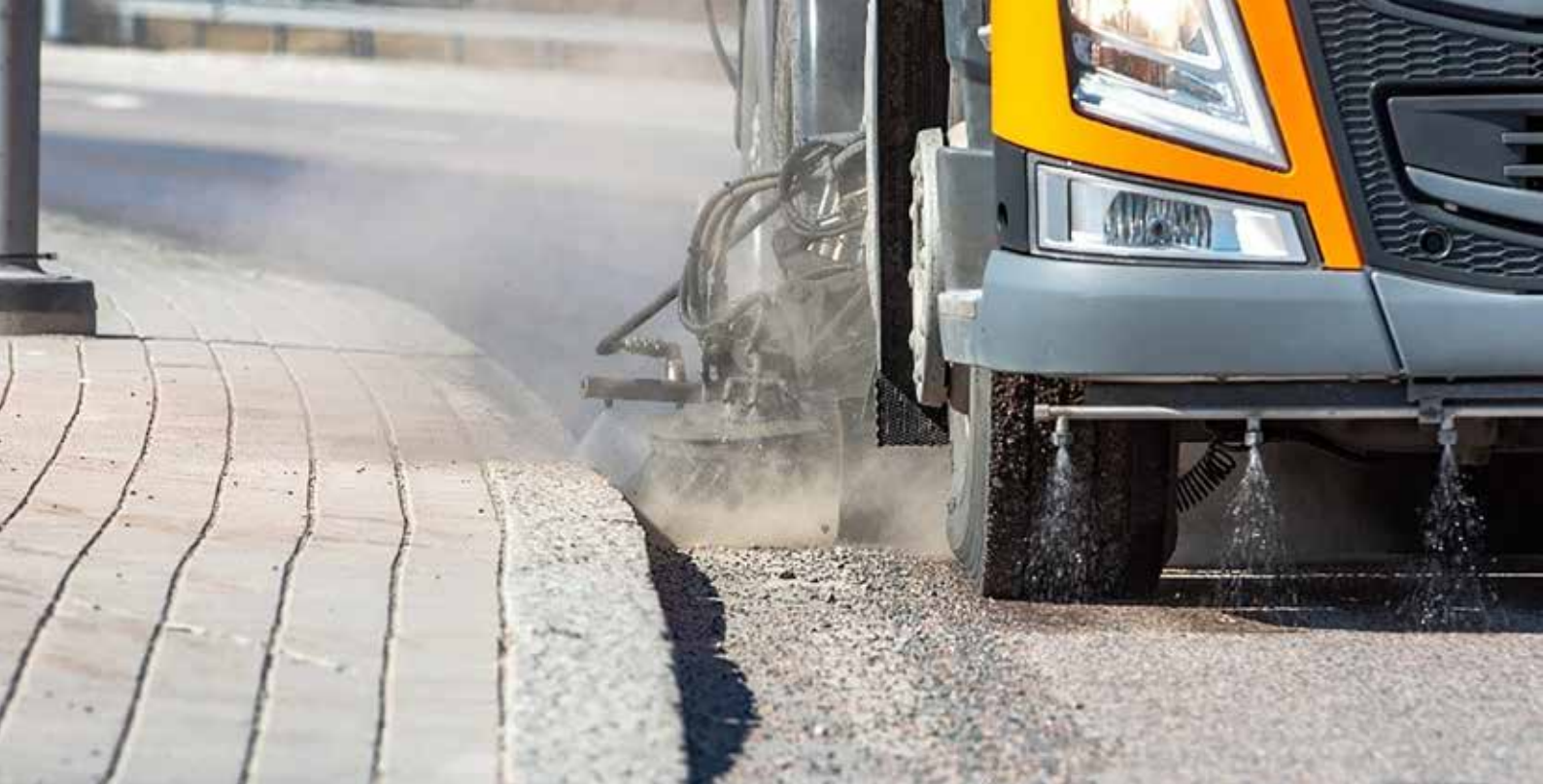
Karkean materiaalin poistoa PIMU-laitteistolla.
